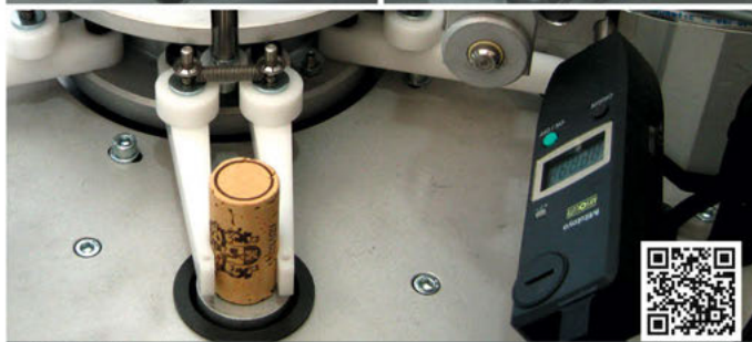
MEDCORK medição de comprimento, diâmetro, peso e humidade
